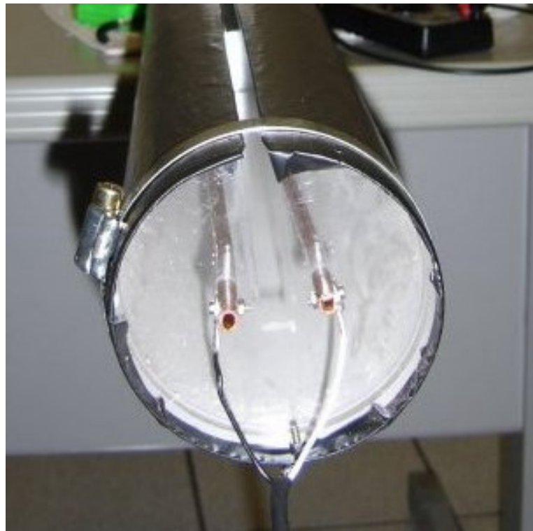
Figura32 – Foto do detalhe de duas barras cilíndricas planas e paralelas
